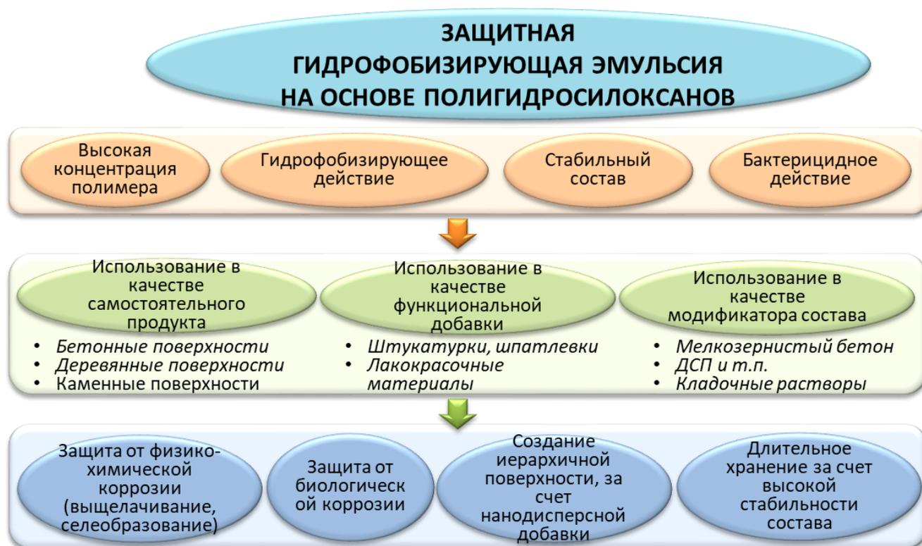
**Рисунок 1.1** – Эффективность применения полигидросилоксановых эмульсий для модификации поверхности строительного материала
